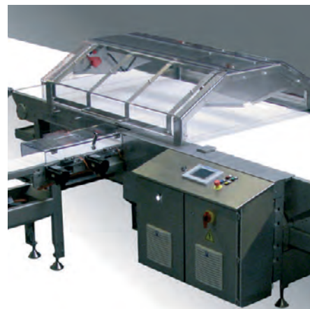
Austragestrator zur Förderung einzelner Schokolade- oder Biskuitreihen aus einem Produktfluss zur Beschickung einer Verpackungsmaschine.
