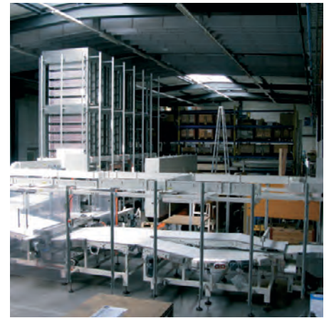
Aufbau einer Verpackungsline mit Produktflussregulator (Produkte Puffer).
