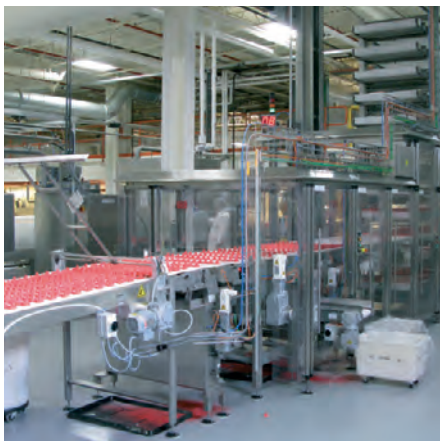
Mehrlagen Band-Speichersystem zum Kühlen und/oder Puffern von Produkten (wie z.B. Marshmallows) vor dem Verpackungsvorgang.
