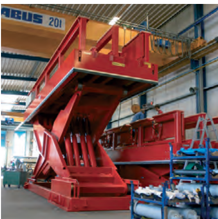
LAWECO Schwerlasthubtisch mit einer Traglast von 70 Tonnen.
