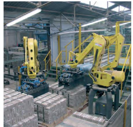
Handling von Ziegeln mit Roboter.
