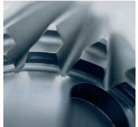
Werkstück nach der Endbearbeitung beim Verzahnungsschleifen.
