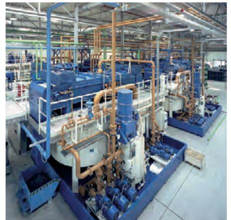
HOFFMANN-Druckbandfilter HKF | DBF eignen sich für die Filtration von Ölen, Emulsionen, synthetischen Lösungen, Prozesswasser und anderen Flüssigkeiten.
